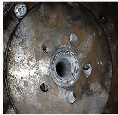
Узел подачи дезоксидирующего продукта на внутреннюю поверхность гильзы
