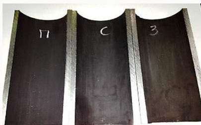
Внутренняя поверхность образцов НКТ 73,0x5,5 мм (ПАО «ТАГМЕТ»), прокатанных с использованием СДП-102
